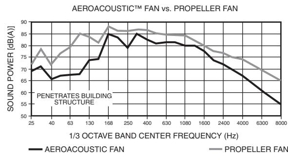
**AEROAUDIOSTIC FAN VS PROPELLER FAN**
