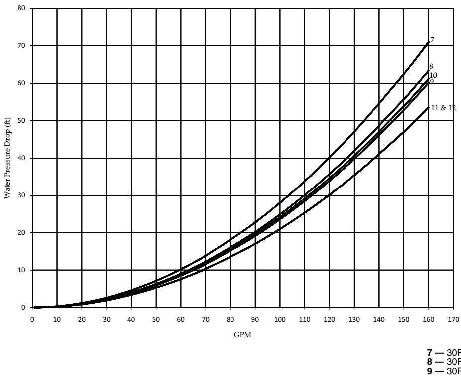
UNIT PRESSURE DROP — SINGLE PUMP HYDRONIC PACKAGE — 30RAP010-030 (SI)
