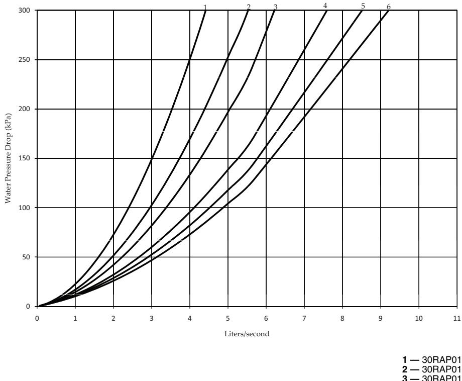
**UNIT PRESSURE DROP — SINGLE PUMP HYDRONIC PACKAGE — 30RAP035-060 (SI)**
